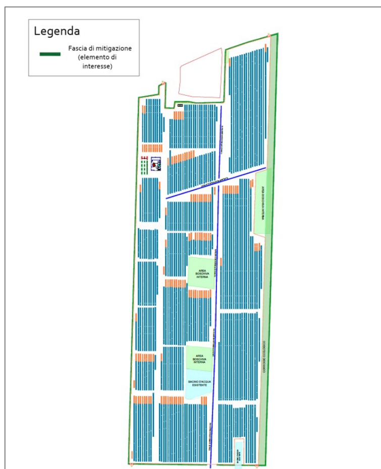
Figura 6.4 – Tavola del Layout di impianto con dettaglio fascia di mitigazione
